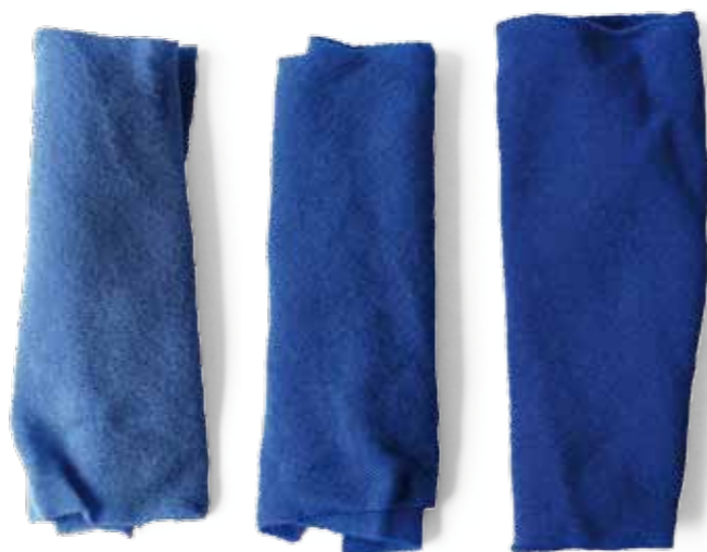
Verbesserung der Färbbarkeit eines Polyolefins durch das Blenden mit Polyamid und Polyester; Bild: © IVW
