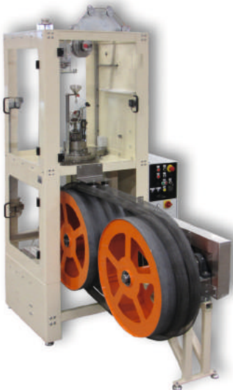
Herstellung von Drahtummantelungen – aus Draht von bis zu 1 mm Durchmesser.
