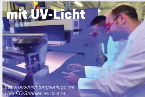
Laborbeschichtungsanlage mit UV-LED-Strahler. Bild © STFI
